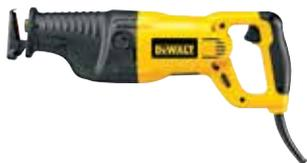
1200W Κινητήρας αποδίδει αυξημένη ισχύ για εφαρμογές βαρέως τύπου. Εκκρεμής κίνηση αποδίδει γρήγορη κοπή σε εφαρμογές ξύλου 0-2600 σ.α.λ και 28χιλ. διαδρομή λάμας για γρήγορη και αποτελεσματική κοπή υλικών Πέλαμα ρυθμιζόμενο εύκολα, χωρίς την χρήση κλειδιού, ρυθμίζει το βάθος της κοπής και αυξάνει την ζωή της λεπίδας.
