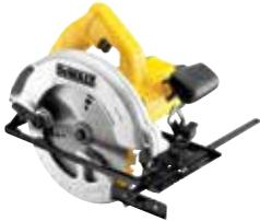
Κόμπακτ, ελαφρύ και εύχρηστο δισκοπρίο με βάθος κοπής 65χιλ. Ισχυρός κινητήρας 1350W για αυξημένη απόδοση κοπής. Εσωτερικός προφυλακτήρας κοπής για αυξημένη ορατότητα πάνω στην επιφάνεια κοπής. Φουσητήρας σκόνης απομακρύνει τα πριονίδια από την γραμμή κοπής.
