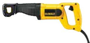
Κινητήρας 1050 watt σχεδιασμένος για εφαρμογές βαρέως τύπου Σφικτήρας λεπίδας 4 θέσεων επιτρέπει τη γρήγορη κοπή και αυξάνει την ευελιξία Με μήκος διαδρομής 29χιλ. η DW304PK παρέχει εξαιρετική απόδοση κοπής Σφικτήρας λεπίδας με μοχλό και χωρίς κλειδί για γρήγορη και εύκολη αλλαγή της λεπίδας κοπής
