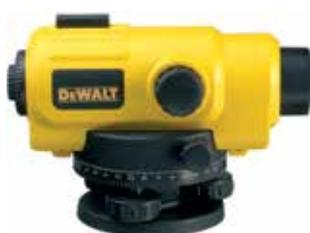
Μεγέθυνση 26x για απόσταση 100 μέτρων+
