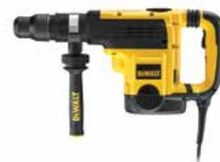
Ιδανικό για σπές διαμερείς και στερέωσης σε ακυρόδεμα και τοίχο διαμέτρου από 18 έως 48χιλ. Διάτρηση μήκους μέχρι τα 115χιλ. Σύστημα AVC στην πίσω λαβή για μείωση των κραδασμών. Εργονομικός, κόμπακτ σχεδιασμός που αυξάνει τον έλεγχο και προσφέρει εύκολη πρόσβαση σε περιορισμένους χώρους. Ηλεκτρονική ρύθμιση ταχύτητας και κρουστικής ενέργειας.
